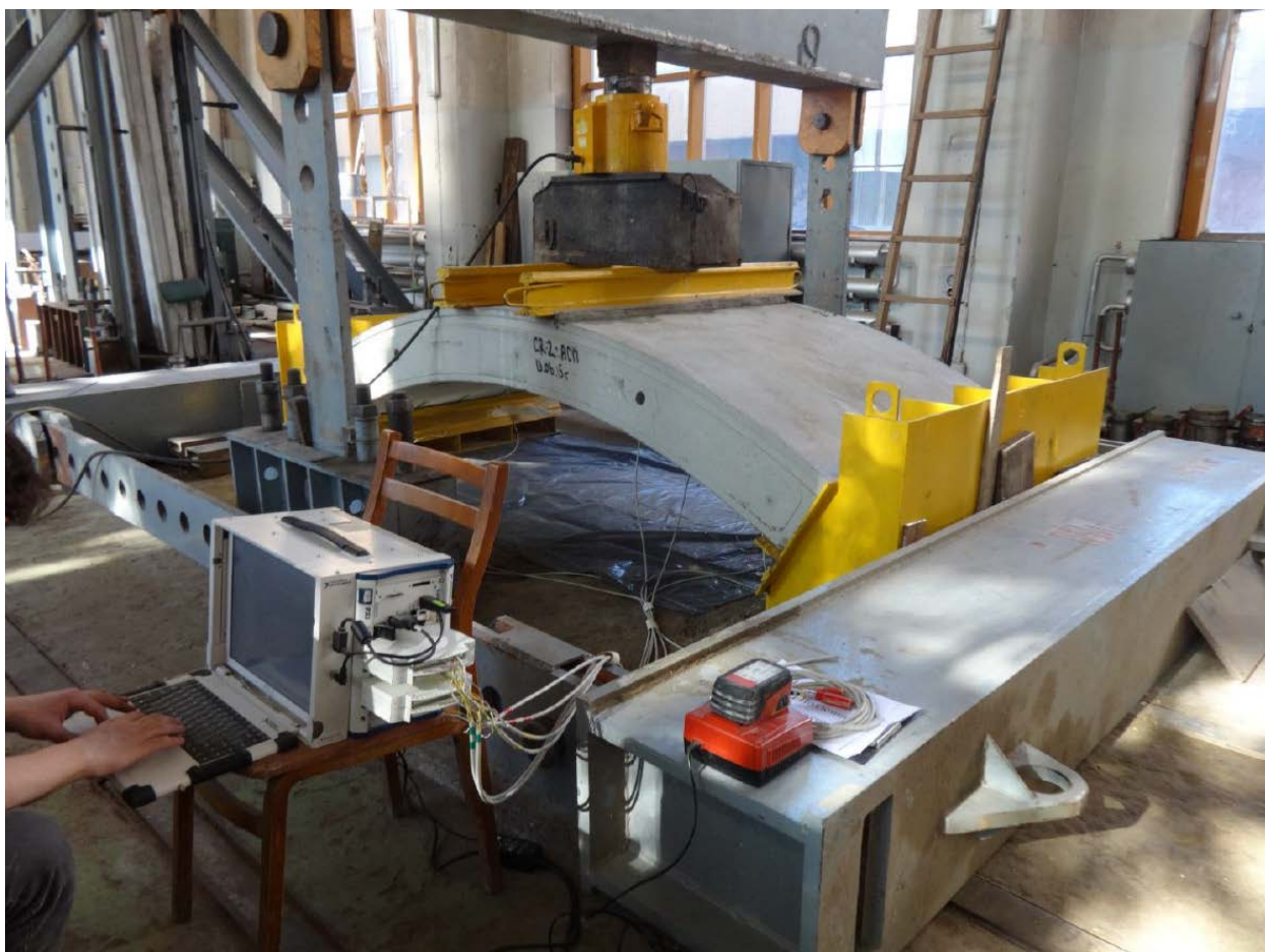
Рис.4.1.2. Общий вид тестового стенда с установленным экспериментальным блоком обделки.
