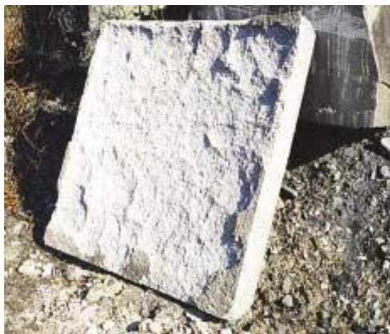
Приложение 4: укрепленная сеткой плита: 15-мин испытание огнём.
