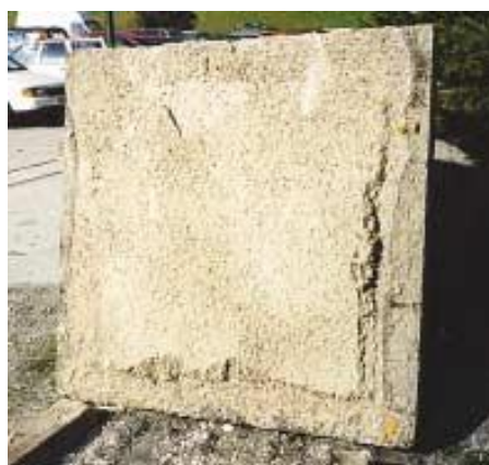
Приложение 6: Стальная + микропропиленовая плита после 2 часов испытания.
