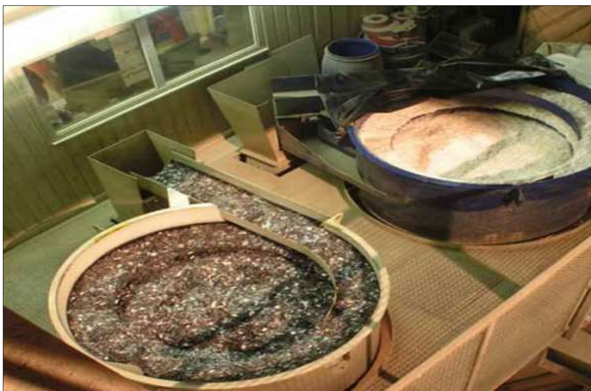
Рисунок 1 - Типовой внешний вид и конфигурация дозирующе-подающего устройства для подачи фибры.
