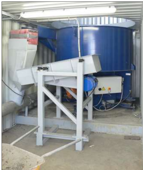
Рисунок 3 - Бункер взвешивания на ячейке загрузки для системы дозирования микрофибры.
