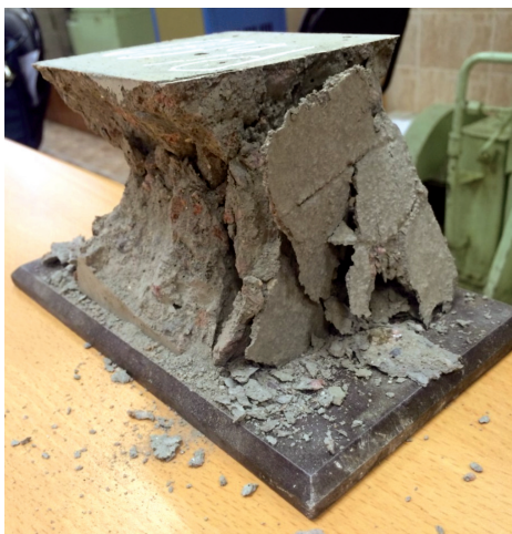
Рисунок 3. Образец из бетона без добавки фибры после проведения эксперимента
