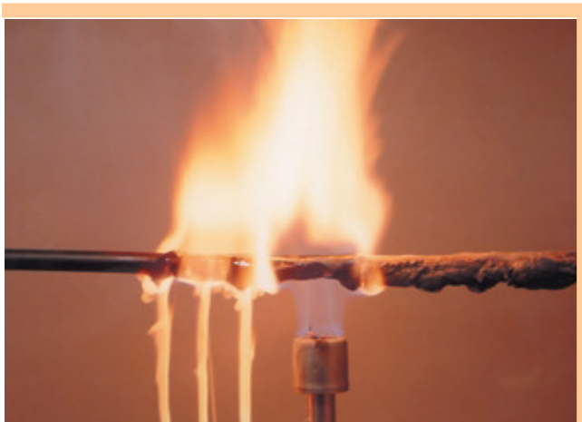
Без покрытия /распространение горения и горящие стекания
