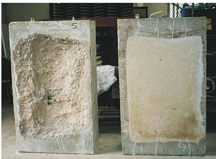
Добавление в бетон очень тонкой фибры «PROZASK IGS» в сочетании с другой конструктивной фиброй значительно повышает огнестойкие свойства бетона высокой плотности. Данная фибра расплавляется при температуре ок. +160 °С, создавая микропоры и микроканалы в бетоне, через которые может мигрировать пар. Таким образом, давление пара понижается, а внутренние напряжения в бетоне не достигают критических значений разрушения.
