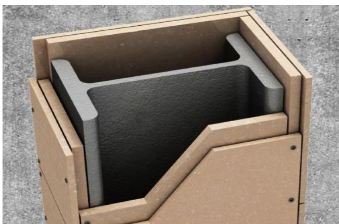
Огнезащита металлических конструкций
