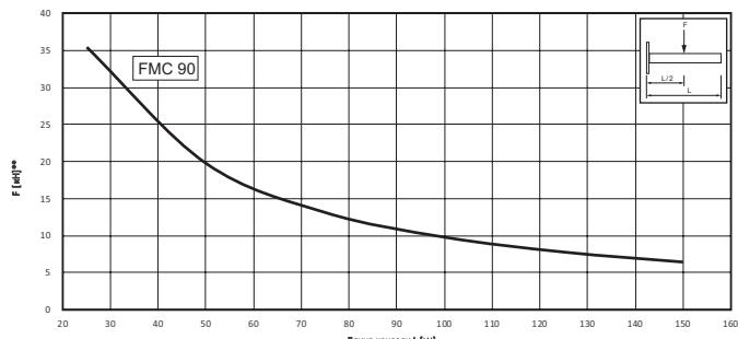
\*\* Допускаемое напряжение рассчитывается по EN 1993;  $\sigma_{empf} = f_y k / (\gamma_L * \gamma_Mo)$  с  $\gamma_L = 1,4$  и  $\gamma_Mo = 1,0$ . Мин. значения допускаемого напряжения (сдвиг, изгиб или в сочетании) или максимальный прогиб ( $L/150$ ) имеют определяющее значение.
