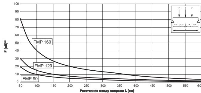
\*\* Допускаемое напряжение рассчитывается по EN 1993;  $\sigma_{rec} = f_{yk}/(\gamma_L * \gamma_M)$  с  $\gamma_L = 1,4$  и  $\gamma_M = 1,0$ . Мин. значения допускаемого напряжения (сдвиг, изгиб или в сочетании) или максимальный прогиб ( $L/200$ ) имеют определяющее значение.
