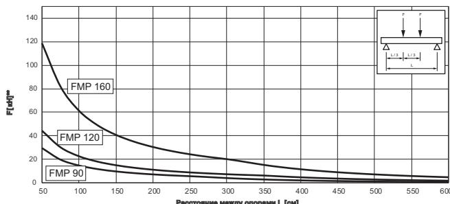
\*\* Допускаемое напряжение рассчитывается по EN 1993;  $\sigma_{rec} = f_{yk}/(\gamma_L * \gamma_M)$  с  $\gamma_L = 1,4$  и  $\gamma_M = 1,0$ . Мин. значения допускаемого напряжения (сдвиг, изгиб или в сочетании) или максимальный прогиб ( $L/200$ ) имеют определяющее значение.
