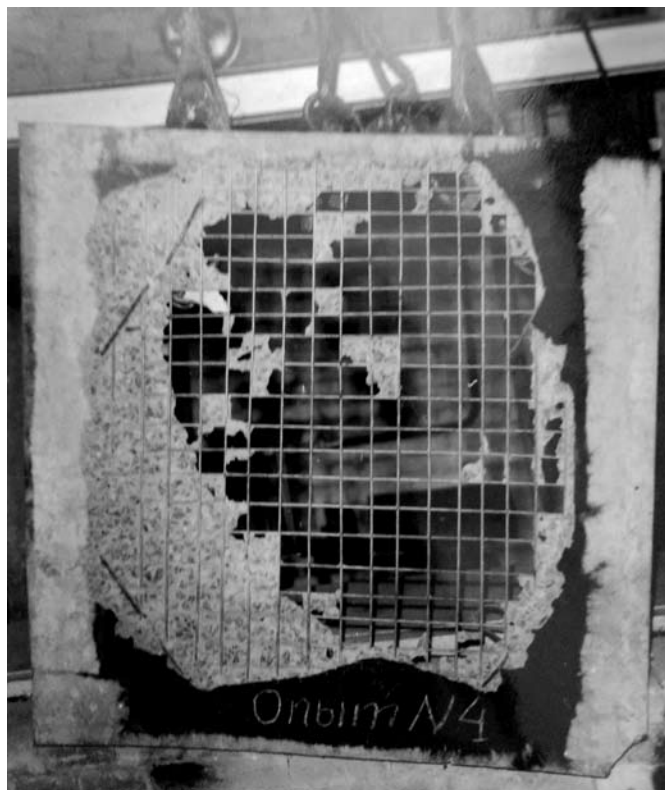
Рис. 3. Вид плиты (модели нижней полки коробчатого настила) после взрывообразной потери целостности при испытаниях на огнестойкость
