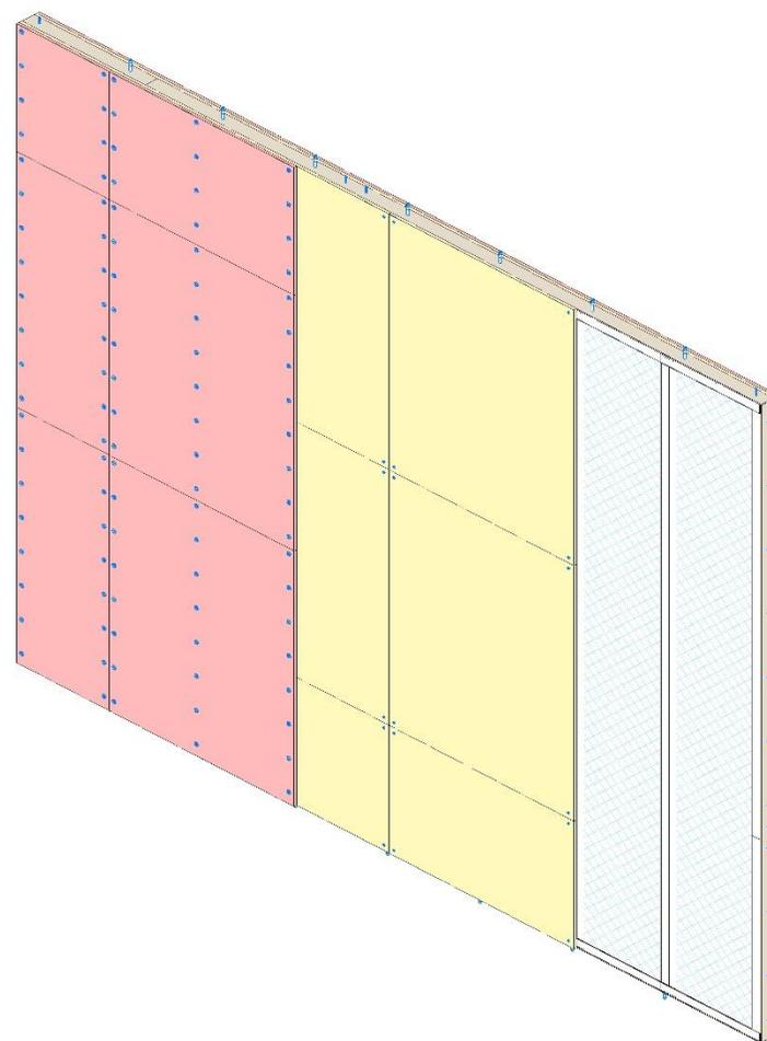
**ПРОЗАСК- схема устройства ограждающей противопожарной конструкции из минеральных плит и огнезащитных плит**
