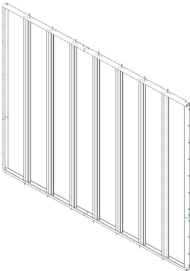
**ПРОЗАСК-схема устройства каркаса из несущих и направляющих профилей**
