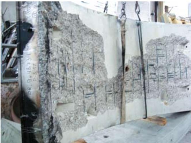
Так выглядит блок тоннельной обделки для тоннелей диаметром 6 м после проведения огневых испытаний под нагрузкой во ВНИИПО МЧС России. Взрывообразное разрушение бетона началось уже на 25-й минуте.
