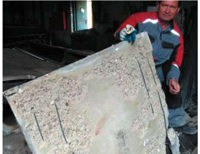
Результат взрывообразного разрушения бетона во время огневых испытаний на базе ВНИИПО МЧС России в 2017 г. при выполнении научно-исследовательской и опытно-конструкторской работы по теме: «Проведение огневых испытаний и формирование требований к огнестойкости и огнесохранности железобетонных конструкций», ФАУ ФЦС (Минстрой России), НИЦ «Строительство», НИИЖБ им. Гвоздева.
